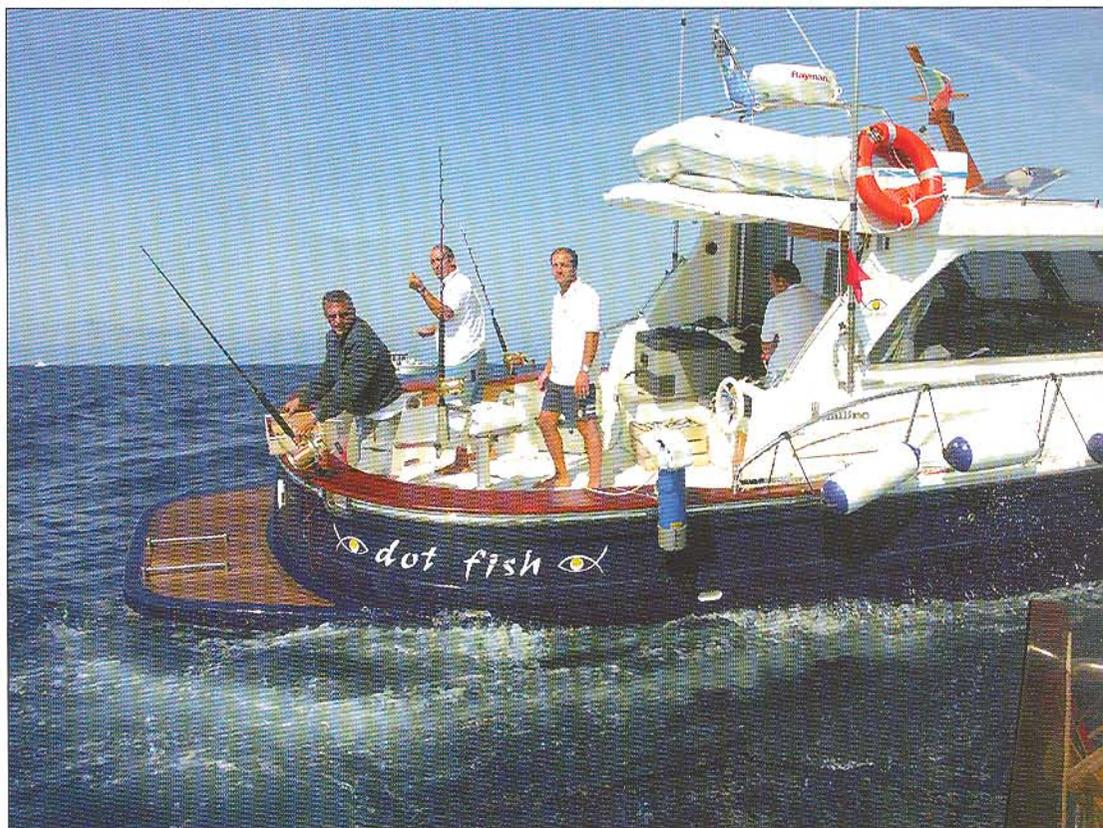
*Ad un buon fisherman è richiesto un pozzetto sgombro da impedimenti e totalmente calpestabile, e con murate di altezza giusta per l'appoggio delle ginocchia.*
